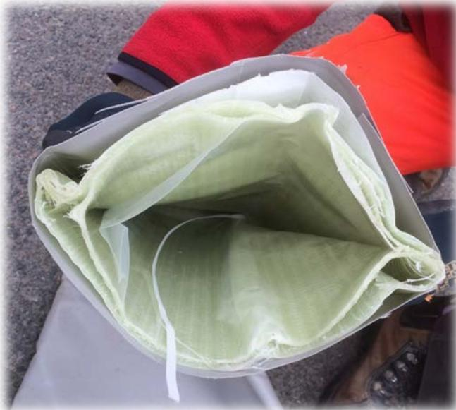
film de protection contre la lumière (UV) avec film de glissement pour l'introduction dans la conduite détériorée et film interne à retirer après polymérisation et avant la mise en service
